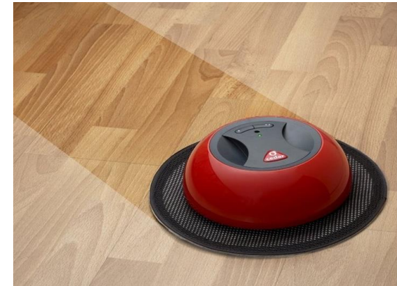
Ein Mini-Bodenroboter, der in Zufallsmustern navigiert, um Räume zuhause zu reinigen.
