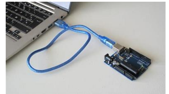
Verbinden Sie den Arduino-Mikrocontroller vor dem Hochladen mit Ihrem Laptop
